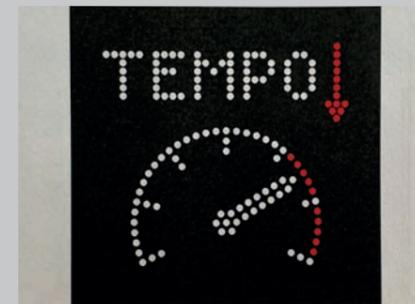
Nach dem Sicherheitsumbau des Kreisverkehrs und dem Fahrbahnteiler vor dem Ortseingang Bahngasse wurde an der stark frequentierten Landesstraße ein Verkehrssignalgeber von Swarco Futurit montiert, um das teilweise noch immer zu hohe Tempo der Fahrzeuge zu bremsen.
